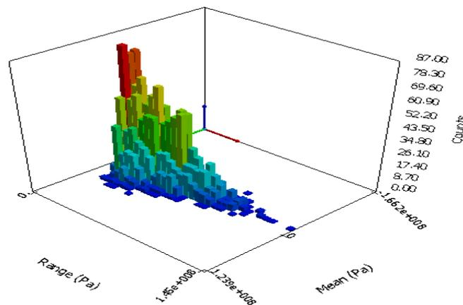
Figure 15. The Rain Flow Matrix [28]
